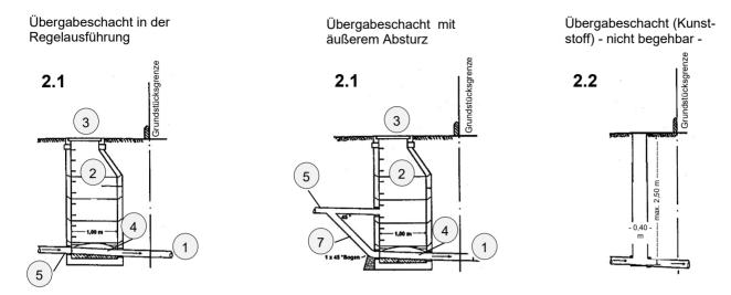
Die Grundstücksentwässerungsanlage im Schnitt. Anschlussleitung ZVO bis max. 1,00 m auf das Grundstück. Dort endet spätestens die Zuständigkeit ZVO, bei =/ < 1,00 m am Anschluss Übergabeschacht. Der Übergabeschacht ist unmittelbar an der Grundstücksanschlussleitung zu setzen.
